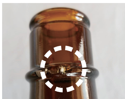
③口欠け：口の部分が小さく欠けたもの
